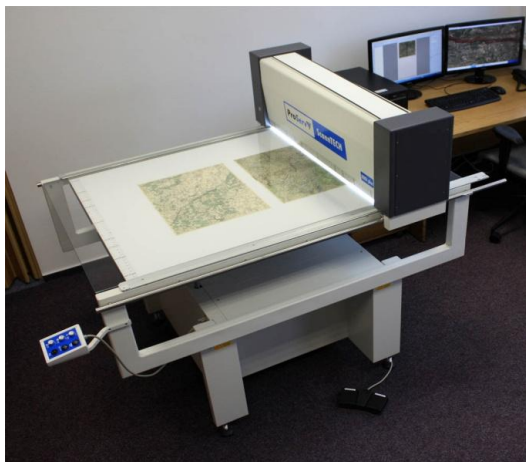
Obr. 3. – Kartometrický skener ScannTech 800 a vpravo integrovaná kolébka pro digitalizaci atlasů.
